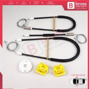
BWR524 VW Golf MK4 1J1 1997-2006 2/3 Kapı HB 1J3837461 1J3837462 İçin Elektrikli Sağ veya Sol Kapı Cam Kriko Tamir Seti
