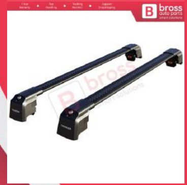
BSRTRX2Black BSRTRX2Siyah Alüminyum Tavan Rafı Çapraz Çubuklar Raylı Taşıyıcı WingBar Kenar, Hırsızlığa Karşı Kilitlenebilir Siyah Renk
